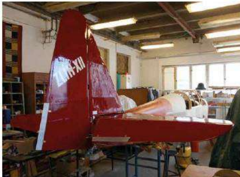
Zkušební sestavení ocasních ploch letounu. Na snímku ještě chybí výztužná lana ocasních ploch. Hliníkové plošky na odtokových hranách byly u Zlínu XII stavitelné pouze na zemi.
