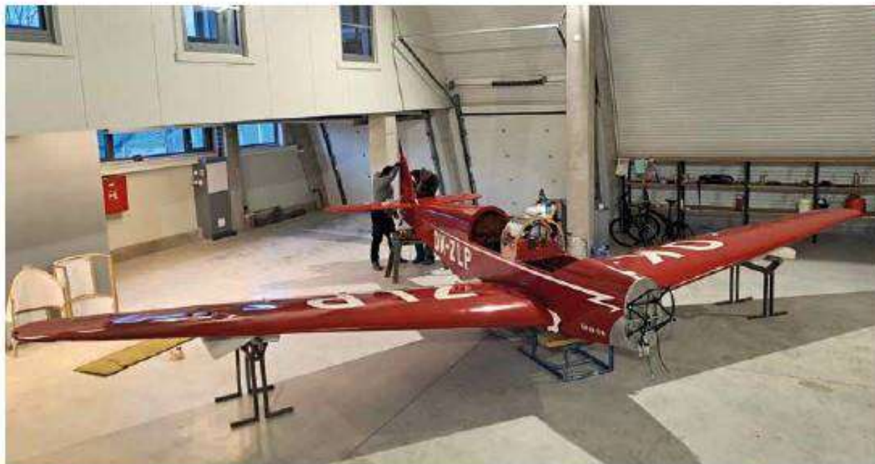
Jiný pohled na konečnou montáž letounu v hangáru. Motorové lože je připraveno pro letecký plochý čtyřválcový motor Continental A65 se kterým stroj již létal a který je svoji konstrukcí nejbližší původnímu motoru Persy II.
