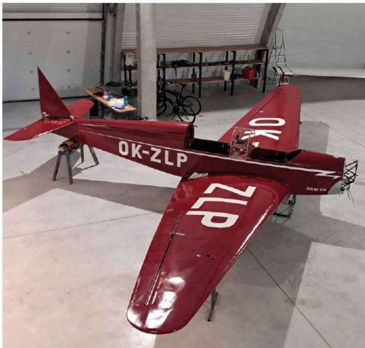
Konečná montáž letounu v hangáru. Trup je bez otvíratelných částí krytu kabiny. Na horní straně křídla ještě chybí snímač tlaku vzduchu pitotstatického systému. Docela dobře je vidět oblouková odtoková hrana křídla.
