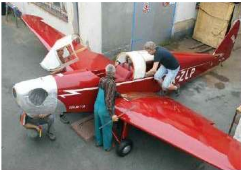
První sestavení letounu před dílnou. To je v případě Zlinu XII vzhledem k řešení uchycení křídla do trupu práce pro čtyři pracovníky a teprve až poté, kdy je křídlo uchycené do trupu, můžete celý letoun zvednout (alespoň v šesti osobách) a konečně namontovat podvozek..
