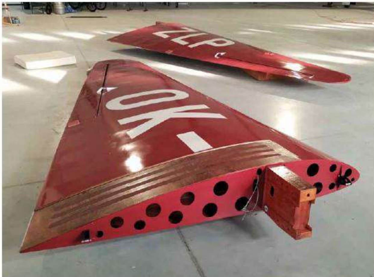
Pohled na hotovou pravou polovinu křídla před konečnou montáží. Na snímku vidíme umístění a rozměry kořenové části hlavního nosníku křídla, kování zadního pomocného nosníku a kování pomocného předního nosníku. Na pravém křídle je umístěn „chodníček“, tedy zesílení, na které je dovoleno stoupat při vstupu do kabiny letounu. Také je vidět lanové řízení křídélka a trochu i oblouková odtoková hrana křídla.
