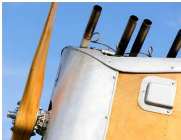
Il quattro cilindri Walter Mikron da 55 hp è stato installato a teste in su, con impianti di alimentazione e lubrificazione appositamente modificati
