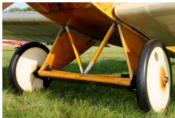
L'asse del treno principale scorre in due corte asole, ammortizzato da matasse elastiche
