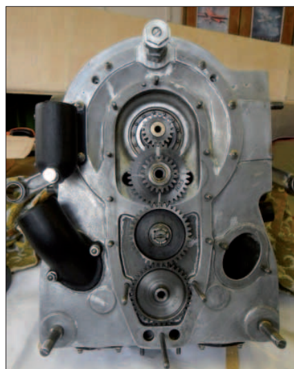
Demontovaný dvouválcový letecký motor Praga B2 během generální opravy
