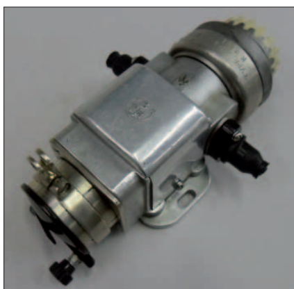
Magneto BTH pro letecký motor Praga B2
