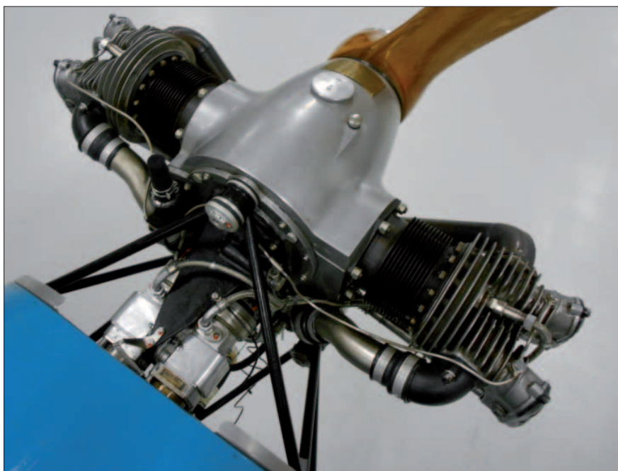
Renovovanou Pragu E.114 Air Baby poháná dvouválec Praga B2 výrobního čísla 1023
